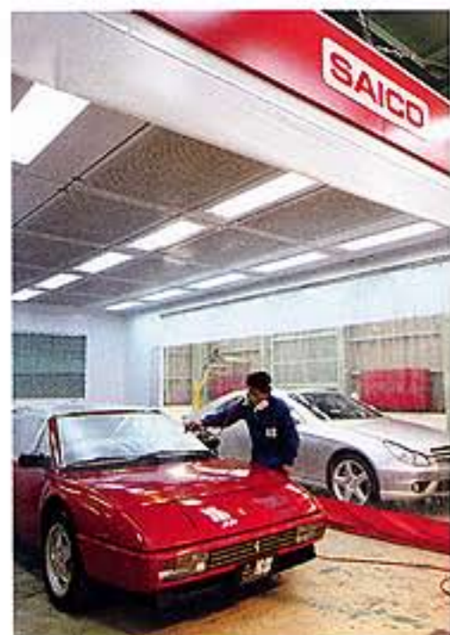
サイコ社製塗装ブースとシロッコファンとの組み合わせにより、清潔な環境下で作業が行える。現在ウォーツFXとのコラボが大人気だ。
