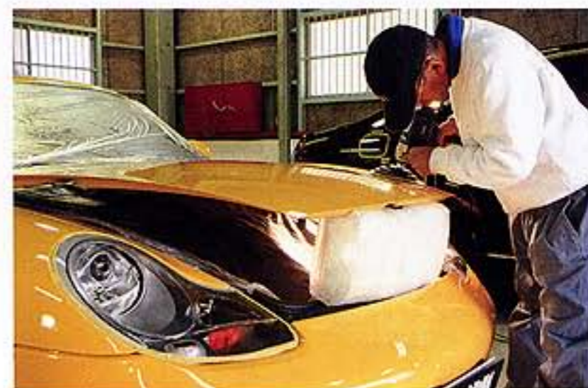
曲面を美しく磨き上げるには、それなりの工夫が必要。均一に圧が掛かるように軟質なブロック材などを挟んで作業を行う。これも同店発案の技術。
