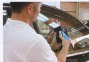
↓ガラスを挟み込んで数値を割り出す最新型の可視光線透過率測定器を導入。担当毎に基準がころころ変わる車検時などに威力を発揮する。
