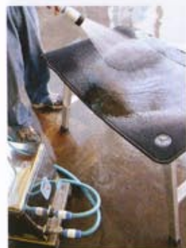
専用のオゾン発生器を経由した水道水で各種作業を施工。消臭効果なども期待できる。老舗ならではの味のあるコダワリ。
